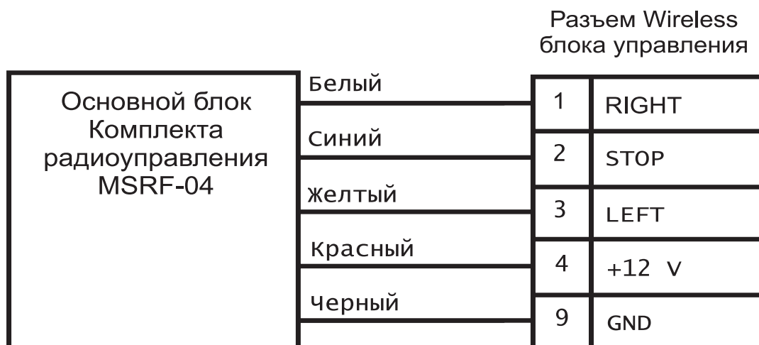
Рисунок 4 - Схема подключения комплекта радиуправления MSRF-04
